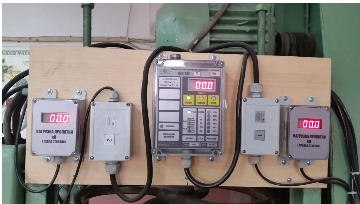
Рис. 2.5. Измерительная аппаратура, установленная на стан 150x235.
